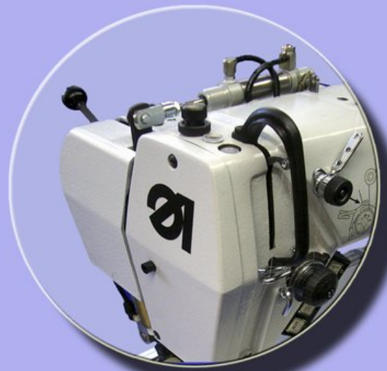
Messerantrieb oberhalb des Nähkopfes, dadurch freier Durchgangsraum
